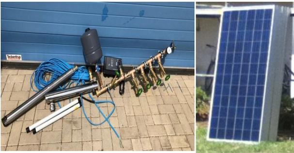
Bestimmte Materialien wie z. B. Solarmodule, Wechselrichter, Batterieanlage, Tiefenwasserpumpe, Wasserbehandlungsgerät, Wasserrohre, Zaun etc. wurden mit einem Container von Deutschland geliefert werden. Den Brunnen selber bohrte eine Firma aus Pemba. Die Brunnenrohre mit den Kieselsteinen konnten ebenso in Pemba gekauft werden.
